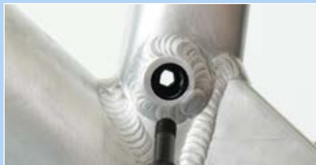
Figura 227: Orificio de la interfaz Postpin
