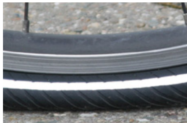
Figura 89: Presión de inflado demasiado baja
