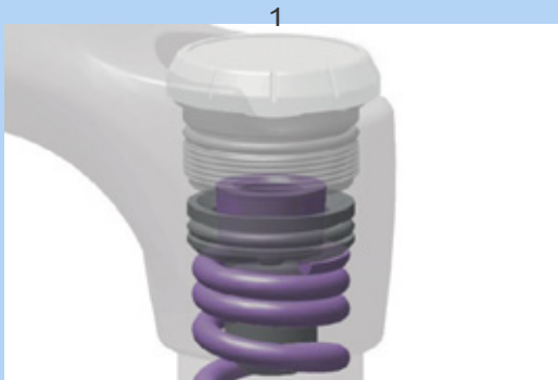
Figura 102: Enroscado y desenroscado del anillo de ajuste de la tensión previa
