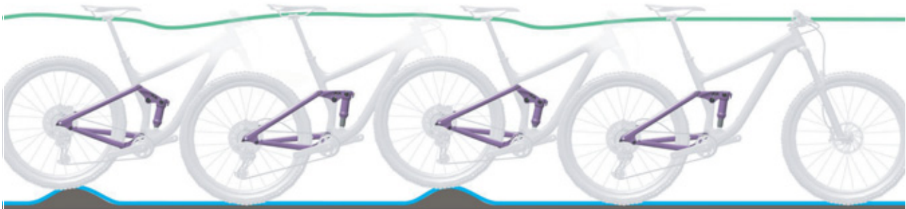
Figura 117: Condición óptima de marcha del amortiguador de la horquilla trasera
