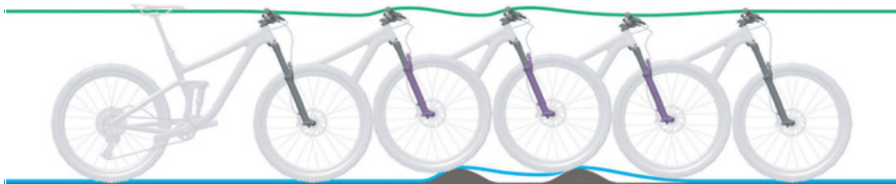
Figura 231: Descompresión demasiado lenta de la horquilla de suspensión
