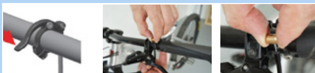
Figura 169: Desmontaje del cartucho
