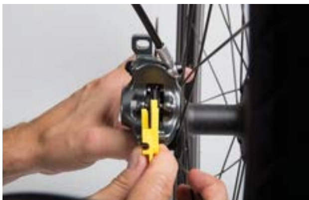
Figura 156: Comprobación de la almohadilla de freno montada con ayuda del seguro de transporte
