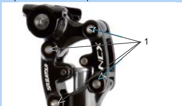
Figura 166: Puntos de lubricación de la tija de sillín de muelle SR Suntour
