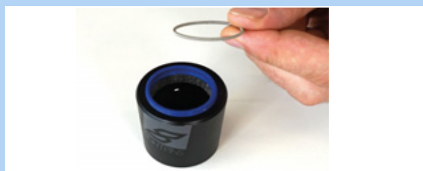
Figura 211: Arandela elástica retirada
