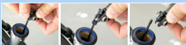
Figura 208: Retirada del cable Bowden
