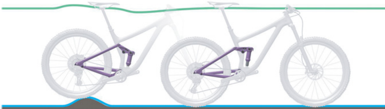
Figura 119: Condición óptima de marcha del amortiguador de la horquilla trasera en caso de irregularidades
