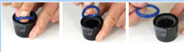
Figura 212: Extracción del rascador
