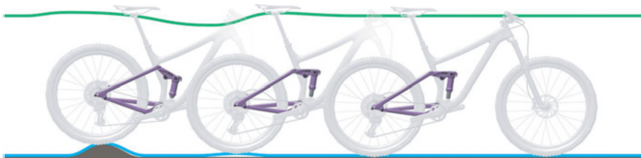
Figura 245: Descompresión demasiado rápida del amortiguador de la horquilla trasera
