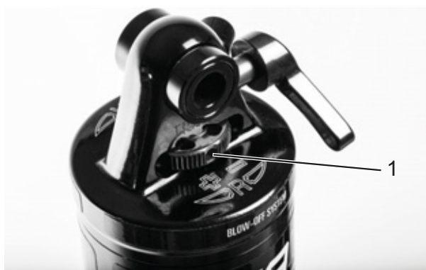
Figura 246: Rueda del regulador de niveles de tracción Suntour (1) en el amortiguador de la horquilla trasera
