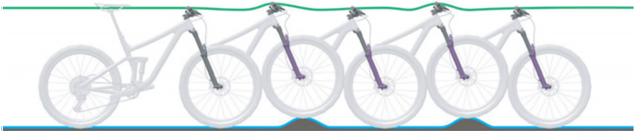
Figura 11: Condición óptima de marcha de la horquilla
