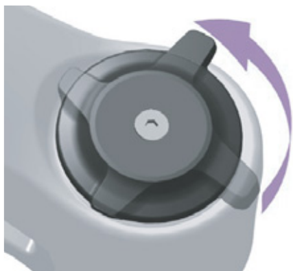
Figura 244: Ajuste para un regulador de niveles de presión más blando
