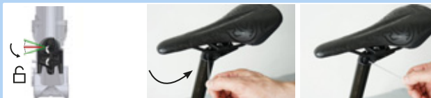
Figura 167: Colocar el accionamiento del ajuste de altura en la "Posición abierta"
