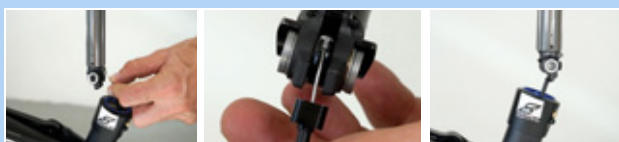
Figura 225: Enganchar e insertar la tija de sillín
