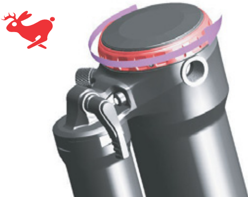
Illustration 110 : Tourner l'amortisseur de détente vers le lièvre
