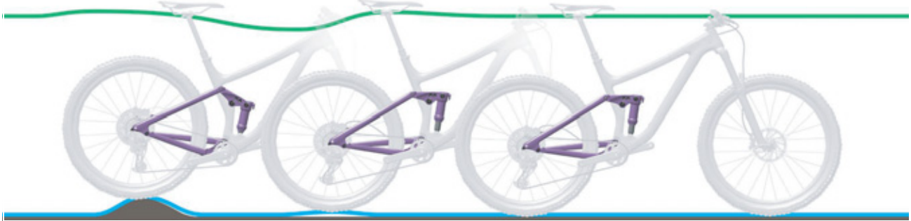
Illustration 107 : Détente trop rapide de l'amortisseur arrière
