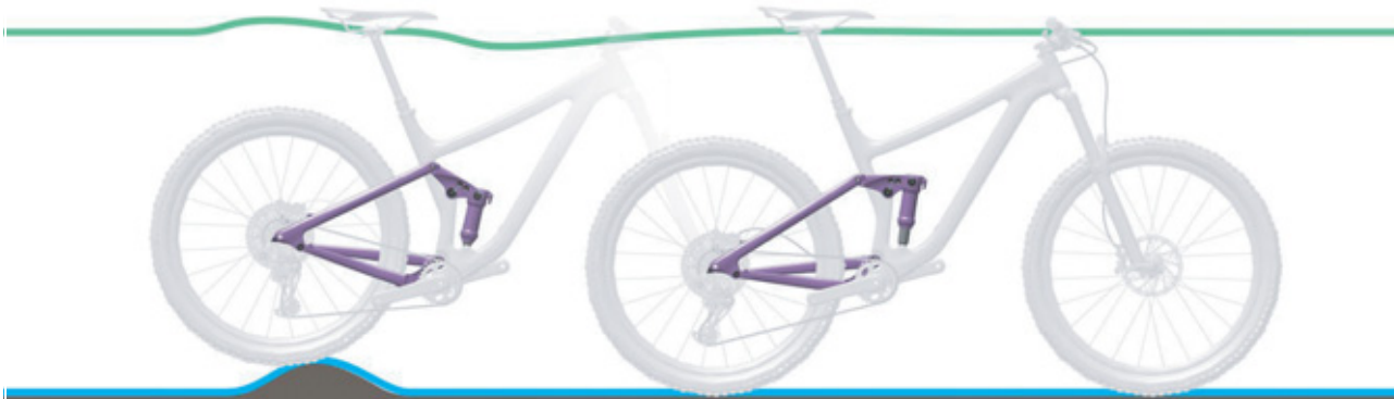
Illustration 64 : Comportement optimal de l'amortisseur arrière sur des irrégularités
