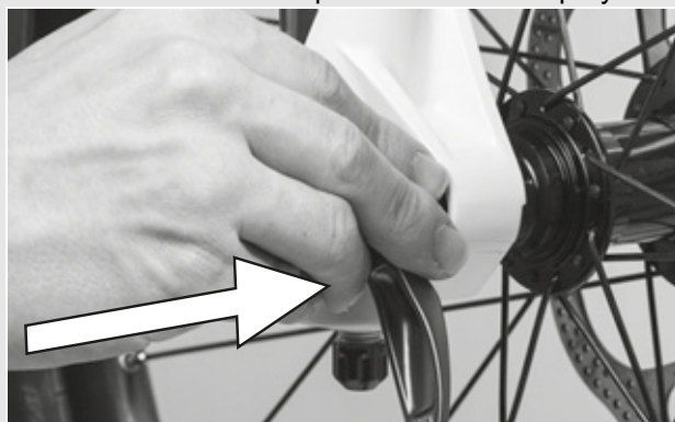
Illustration 40 : Enfoncez l'attache rapide
