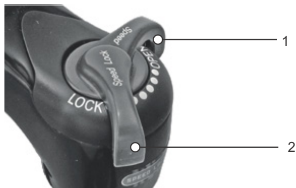
Illustration 88 : Amortisseur de compression Suntour en position ouverte (1) et fermée (2)
