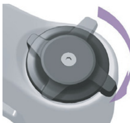
Illustration 89 : Régler le dispositif de réglage de la compression sur un niveau plus dur
