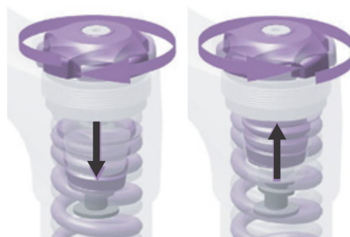
Illustration 52 : Serrer et desserrer l'anneau de réglage de la prétension.
