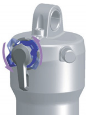
Illustration 66 : Régler le dispositif de réglage de la compression sur un niveau plus souple
