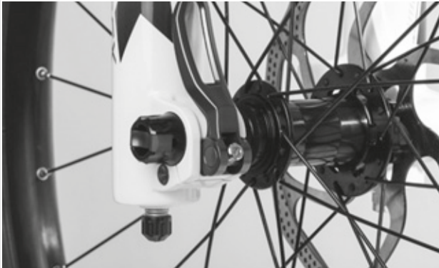
Illustration 94 : Régler la force de serrage de l'attache rapide
