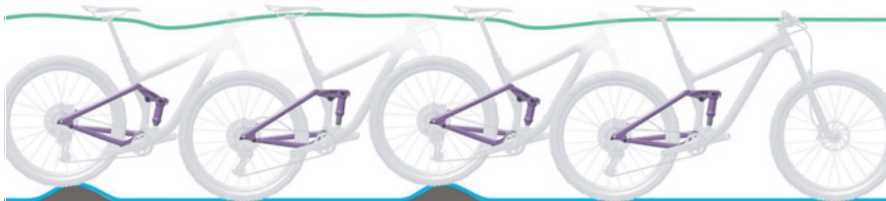
Illustration 10 : Comportement optimal de l'amortisseur arrière
