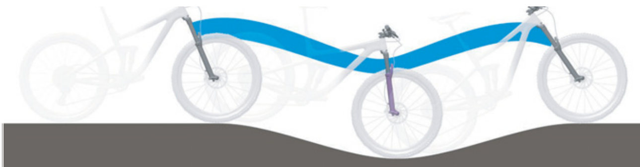
Illustration 86 : Comportement optimal en terrain vallonné
