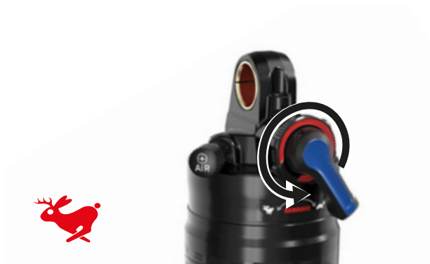
Illustration 62 : Augmenter la vitesse de détente
