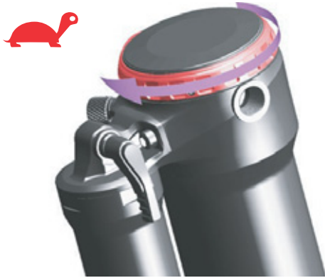
Illustration 108 : Tourner l'amortisseur de détente vers la tortue
