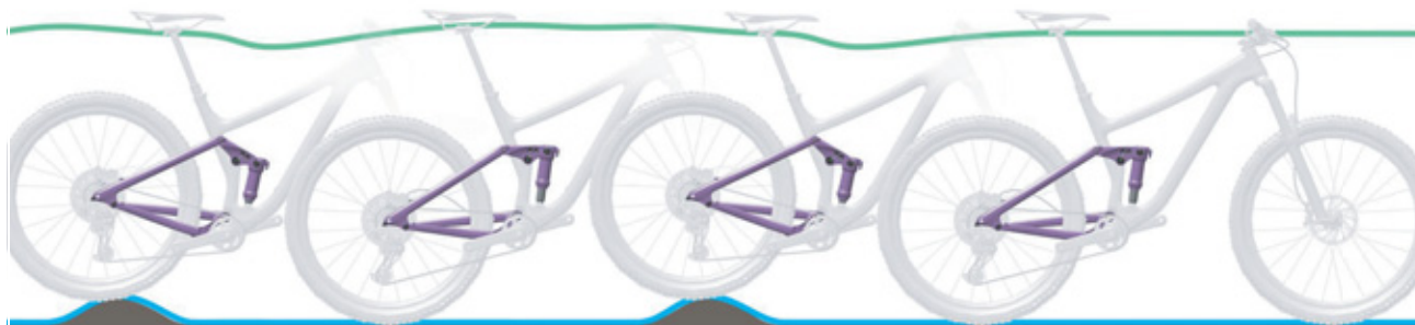
Illustration 59 : Comportement optimal de l'amortisseur arrière
