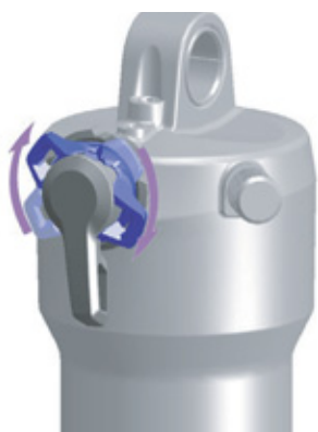
Illustration 65 : Régler le dispositif de réglage de la compression sur un niveau plus dur
