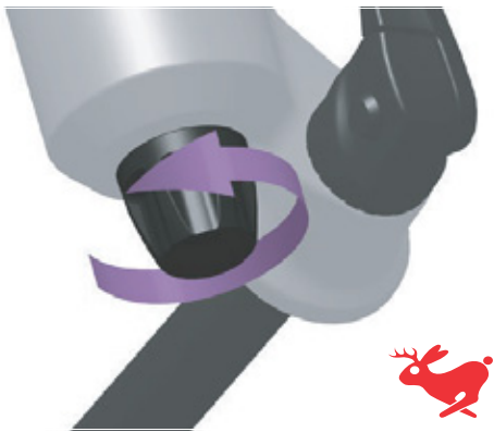
Illustration 102 : Tourner l'amortisseur de détente vers le lièvre
