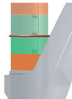
Illustration 55 : Plage de sag prescrite (vert) et plage de sag interdite
