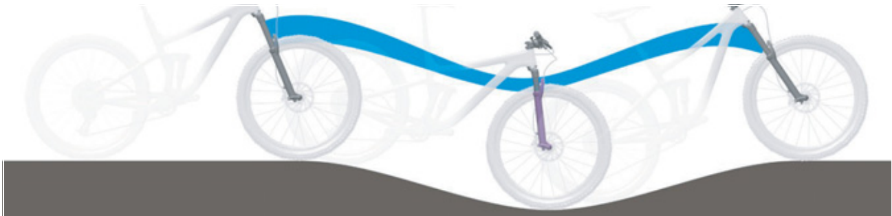
Illustration 103 : Suspension trop souple de la fourche de suspension dans les côtes
