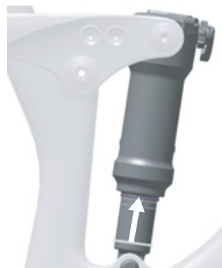
Illustration 57 : Déplacer le joint torique sur l'amortisseur arrière
