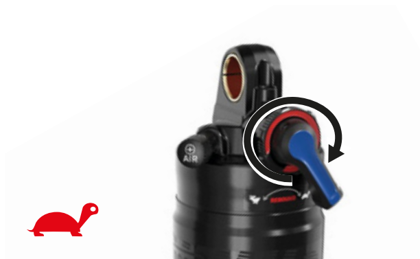
Illustration 61 : Réduire la vitesse de détente
