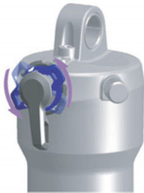
Illustration 114 : Régler le dispositif de réglage de la compression sur un niveau plus souple
