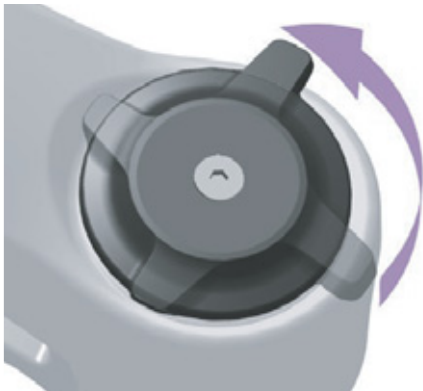
Illustration 106 : Régler le dispositif de réglage de la compression sur un niveau plus souple
