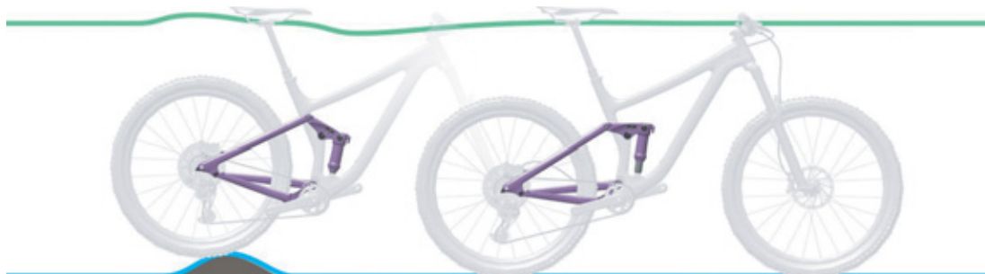
Illustration 12 : Comportement optimal de l'amortisseur arrière sur des irrégularités
