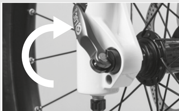
Illustration 42 : Fermer l'attache rapide
