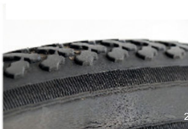
Illustration 138 : Exemples de fissures de fatigue (1) et de fissures d'âge (2)
