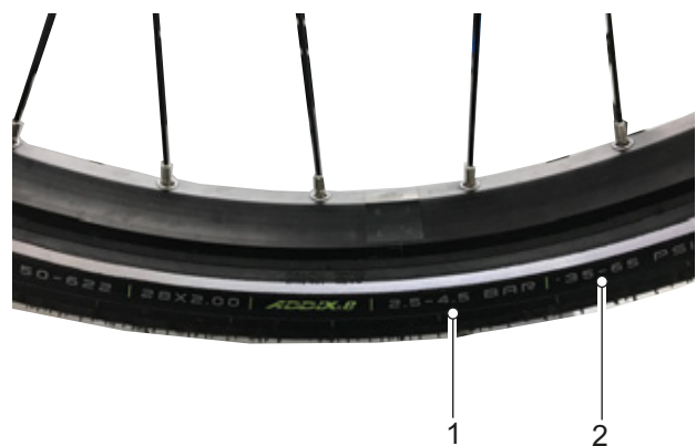
Illustration 136 : Pression des pneus en bar (1) et psi (2)
