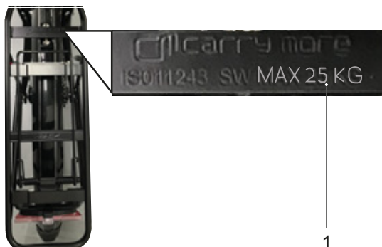
Illustration 116 : La capacité de charge maximale (1) est indiquée sur le porte-bagages.
