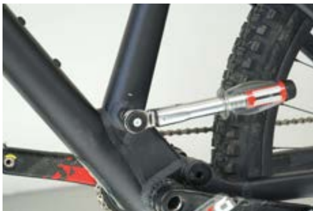
Illustration 81 : Serrer l'axe de la tige de selle
